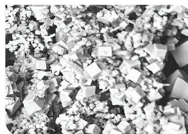
Μικροσκοπική προβολή (x5000) καλή αναπτυγμένου διοξειδίου του χαλκού {Cu(OH) 2 } του προστατευτικού στρώματος που έχει σχηματιστεί στην εσωτερική επιφάνεια του χάλκινου σωλήνα TALOS®.
